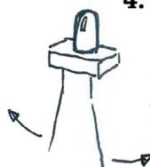
4. Biegt die Drähtchen der Leuchtdiode vorsichtig auseinander und verbindet sie mit den Kabeln. Das jeweils lose Ende der Kabel haltet ihr an die äußeren Metallscheiben.
