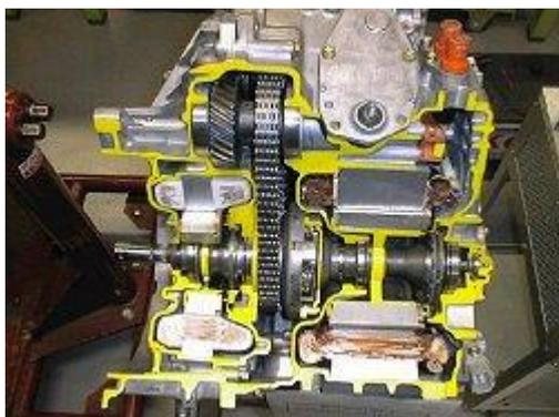
Das Planetengetriebe lässt sich im Foto (Schnittbild) in der Mitte erkennen. Von dort aus erfolgt der weitere Antrieb mit der - im Bild gut erkennbaren - sehr stabilen Kette. Sie führt vom Planetengetriebe aus nach oben zum Achsantrieb.
