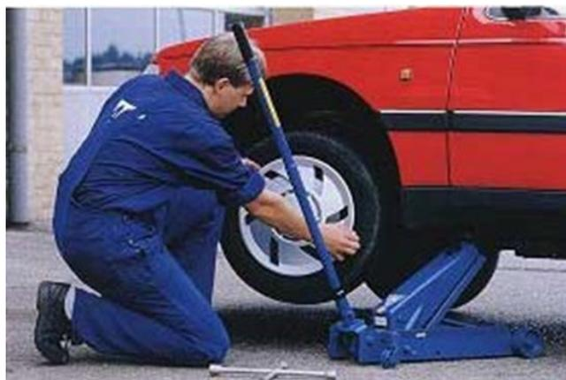
Das obere Bild zeigt die äußere Form eines **Werkstattwagenhebers** und seine praktische Anwendung. Der Arbeitskolben befindet sich verdeckt unter dem Blechpressteil, das auf dem Foto schräg nach oben zeigt und die Last trägt.
